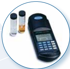
DR 890 filtrový kolorimeter na rýchlu analýzu viac ako 90 metód
